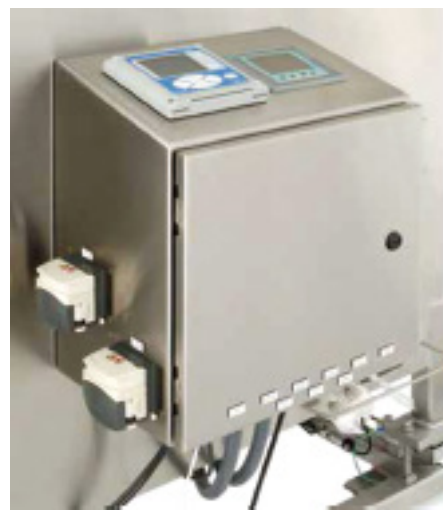
图 2. Xcellerex™ XDUO Quad 混合系统的自动显示面板确保混合趋势以原始和图形形式清晰地显示
