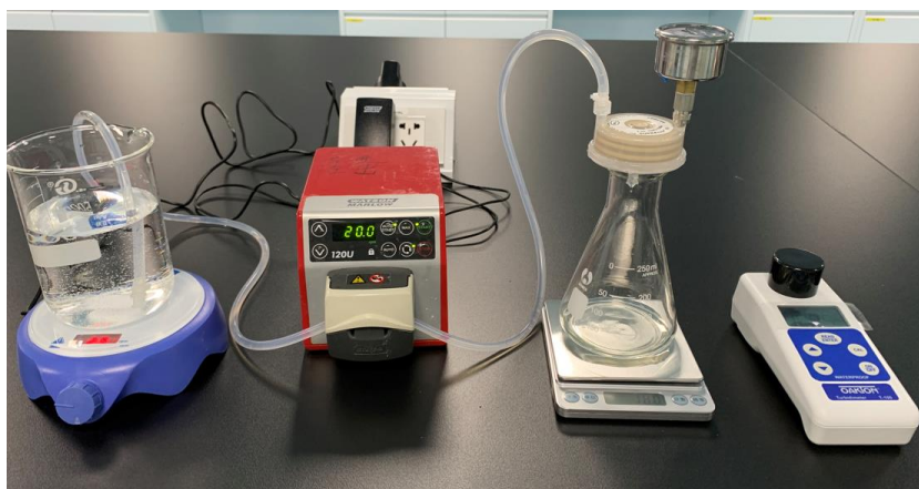
图 3：单级深层滤器连接示意图（压力表）
