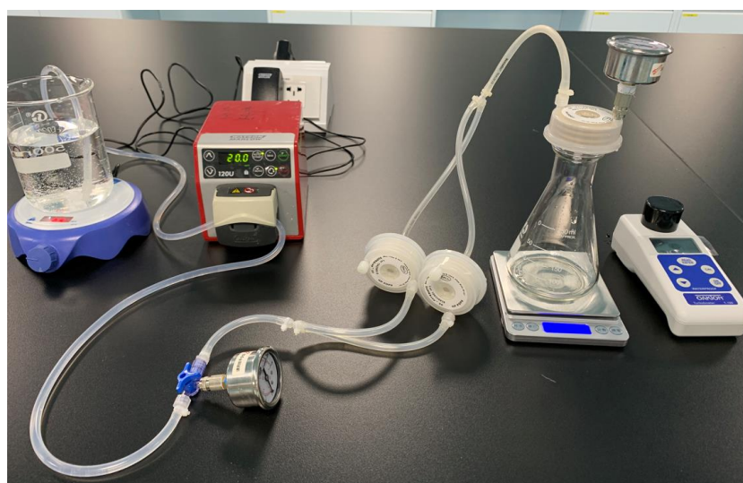
图 4. 两级深层滤器连接示意图
