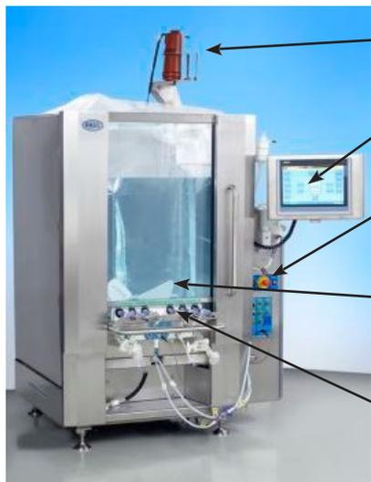
完全性試験可能な、ガンマ線照射済みエンフロン® II フィルターをベントフィルターとして搭載。結露を防ぐヒータージャケット付き
