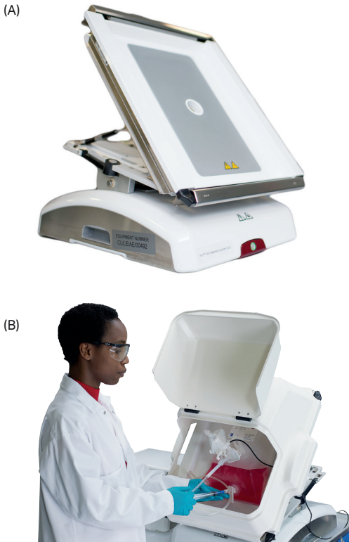
图 3. (A) Xuri™ W25 细胞扩增系统处于倾斜位置。(B) 人体工程学设计使取样和收获等活动变得方便和容易。
