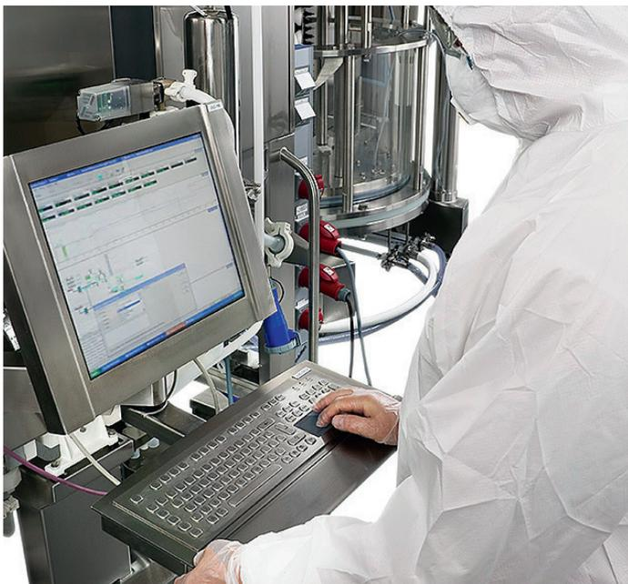
图 5. 与传统装柱相比，智能装填大大简化了使用 ÄKTA™ 系统充装 AxiChrom™ 层析柱的过程。
