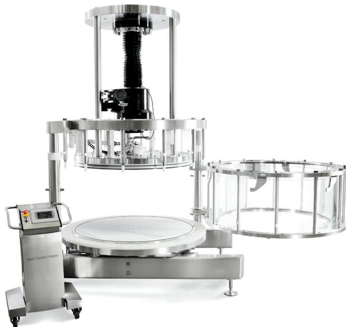
图 8. 摆出模式下的 AxiChrom™ 层析柱可以方便接触到柱床支撑和 O 型环。在多功能设施中，可以快速轻松地更换塑料柱床支撑执行新的操作。
