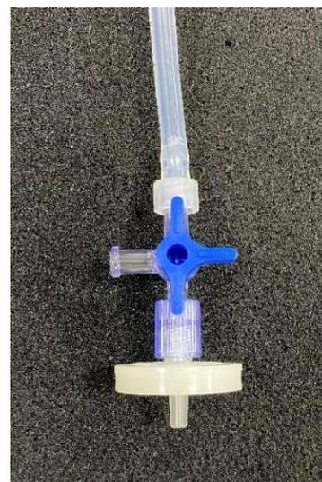
图 3b. 针头滤器安装
