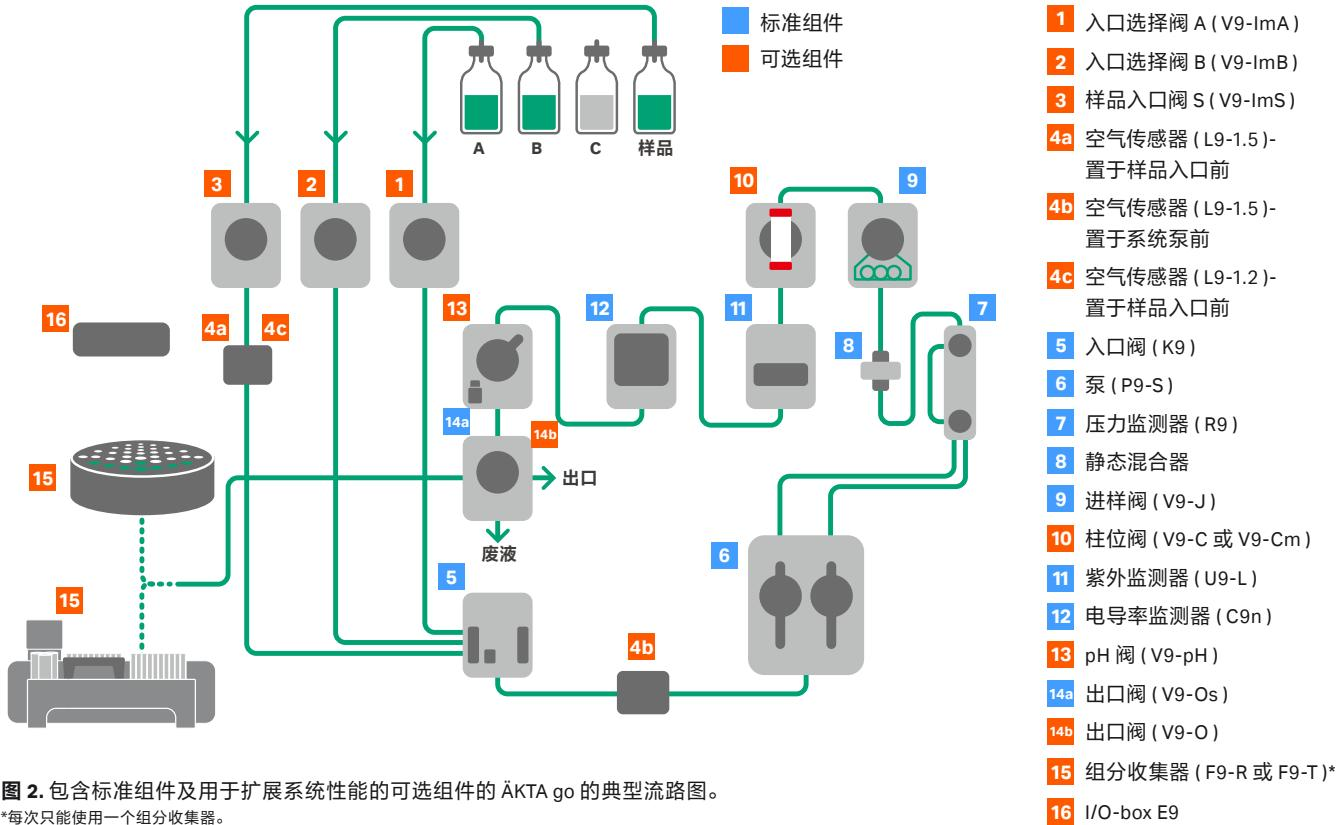
图 2. 包含标准组件及用于扩展系统性能的可选组件的 ÄKTA go 的典型流路图。
