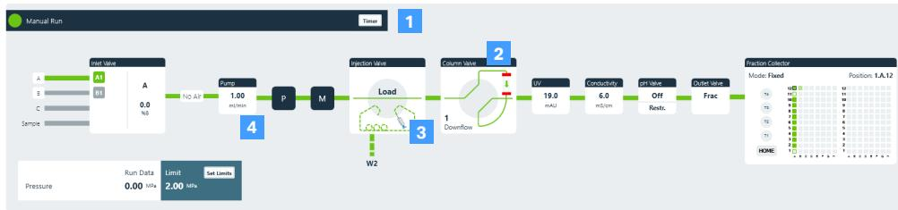
图 7. 流程图展示了系统的流路，并清楚地显示了系统各个组件的放置情况。系统所有部分都是交互式的，并进行了开发改进，以确保整个运行过程、样品和层析柱的整体性。
