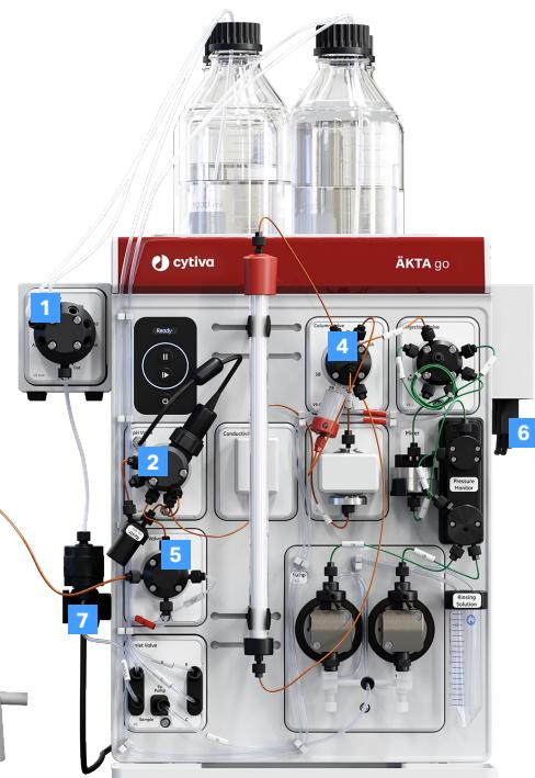
图 4. 可选组件可以添加到系统机身的两个预留位置，或者安装在导轨上以扩展 ÄKTA go 的性能。最多可以同时添加六个可选组件。只能添加一个收集器，F9-T 或 F9-R。
