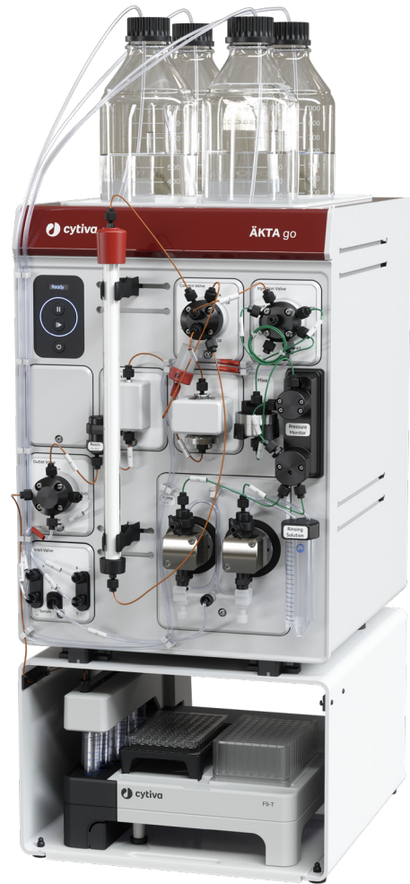
图 1. ÄKTA go 是一个用于常规蛋白质纯化的紧凑型层析系统。
