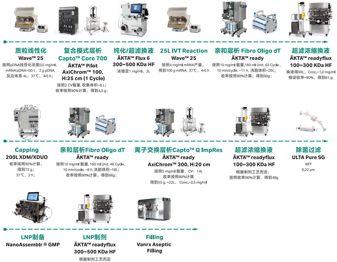
图 5. mRNA 生产工艺配置流程图 (酶法加帽工艺)
