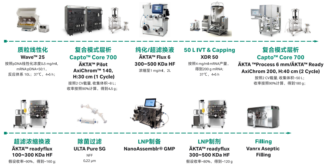
图 6. mRNA 生产工艺配置流程图 (共转录加帽工艺)
