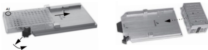
Reagent Rack 1&2 和 96/384 微孔板安装方式
