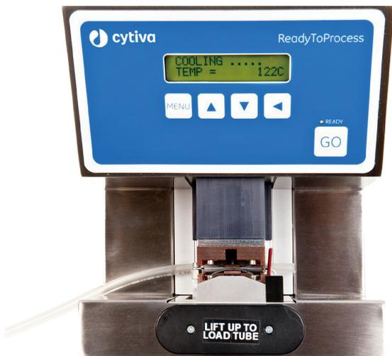
图3. 封管器操作界面。
