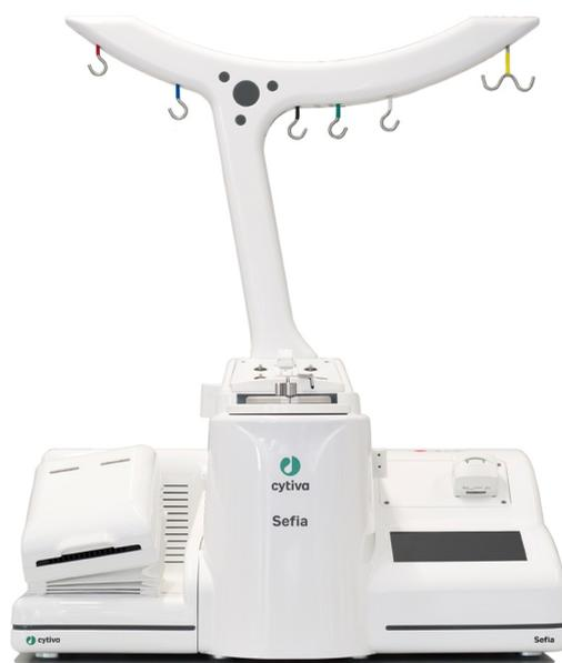
图 1. Sefia™ 全自动细胞处理仪。左侧为带有温度控制的混合器，中间为离心腔，右侧为触摸屏和条形码阅读器(此图中未显示)。顶部的挂袋钩与重量传感器相连。
