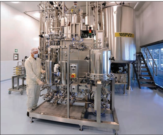
图 5 典型的 Pall 全自动除病毒过滤系统
