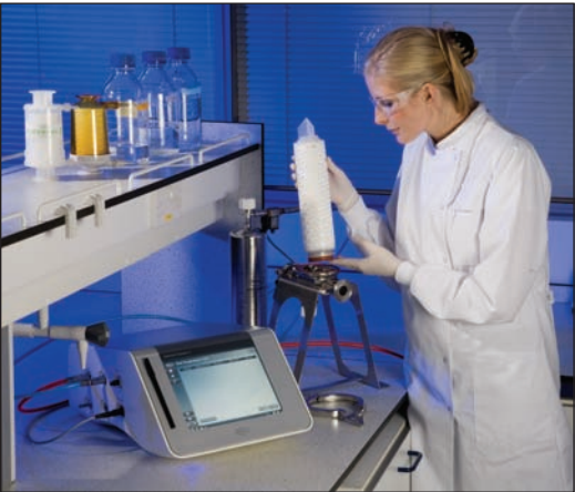
图 4 使用 Palltronic Flowstar 完整性测试仪进行的 Pegasus SV4 除病毒过滤器滤芯完整性测试
