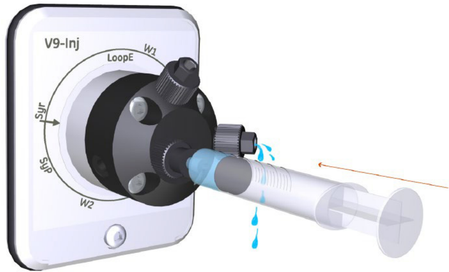
图 4.10. 通过注射缓冲液到进样阀中检查连接 Superloop 底部的端口。
