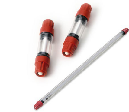
图 A8.2. Precision 层析柱。例子：Mini Q PC 3.2/3( 左图)和Superdex Peptide 3.2/300( 右图)。
