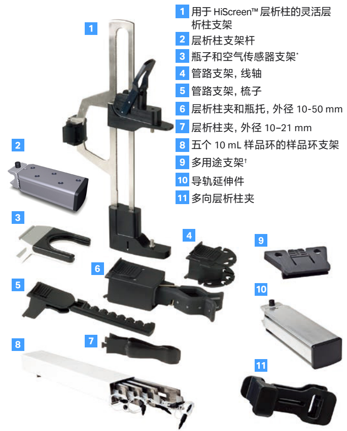
图 13. ÄKTA™ pure 配件包括用于将层析柱、烧瓶和管路连接到系统的支架和夹具 * 要用作空气传感器支架，还需要适配器 28-9563-42 † 例如，用于在系统侧面连接组分收集管架
