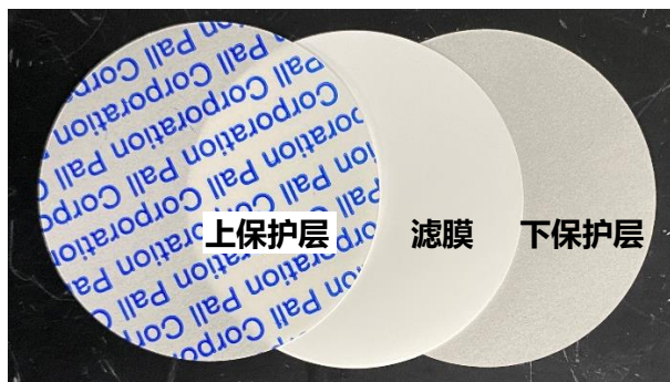
图 2. 预过滤膜区分及安装
