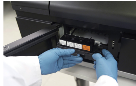
图9. 用户可以轻松添加或更改滤光片，机器可以自动识别并在控制软件中更新，用以创建新的激光和滤光片组合
