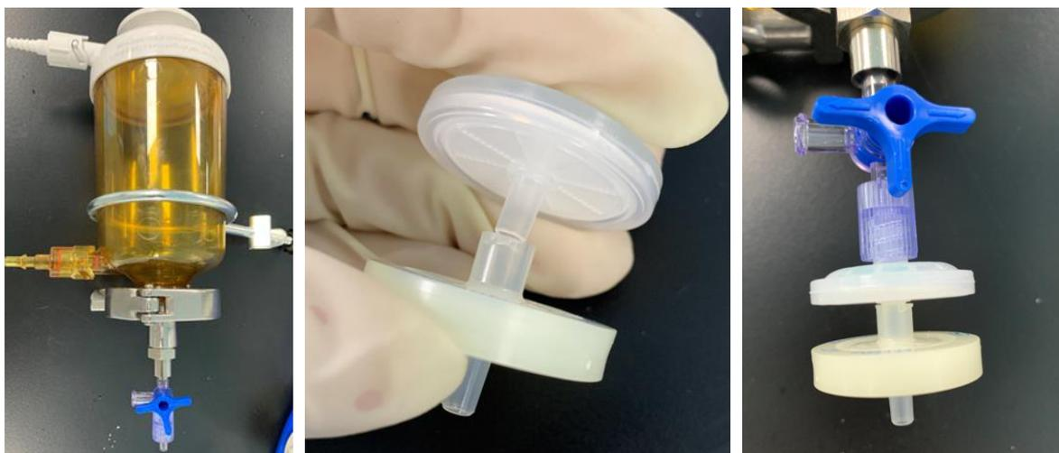
图 2. Microdisc 囊式滤器与压力罐连接方式
